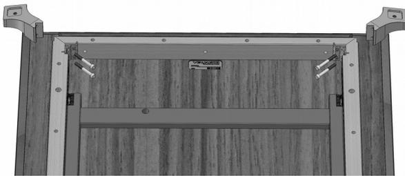
3. Die Gussteile mit je zwei Schrauben M8 x 65 fixieren.
