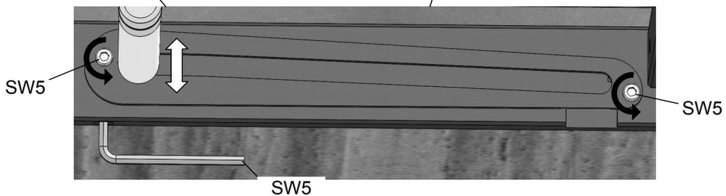
8. ... die beiden äußeren Inbusschrauben etwas lösen. Nun durch Drehen der inneren Inbusschraube die Höhe der Drehstange einstellen. Anschließend die beiden Inbusschrauben wieder festziehen.
